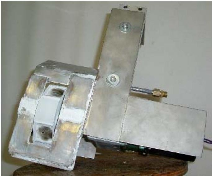
Fig. II.26 : Dispositif de réalisation des dépôts par rotation.
