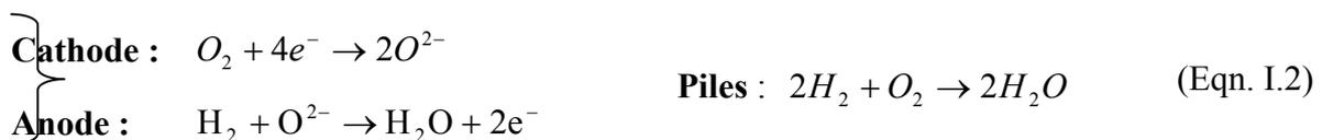
L'hydrogène passe par l'anode et libère deux électrons qui se dirigent vers le circuit externe pour l'alimenter en électricité. Les électrons migrent ensuite vers la cathode où la réduction de l'oxygène de l'air en O<sup>2-</sup> a lieu. Les ions oxygène migrent par la suite par conductivité ionique à travers l'électrolyte pour venir réagir exothermiquement avec les protons H<sup>+</sup> en produisant de l'eau [5] [12].
