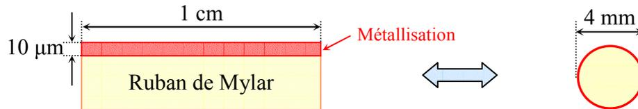
Figure 2-9: Coupes transversales du ruban de Mylar métallisé et du fil métallique équivalent.
