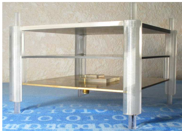
Figure III.27 : Photographie de l'antenne bibande
