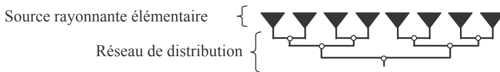
Figure I.3 : Réseau d'antennes schématisé avec son alimentation parallèle
