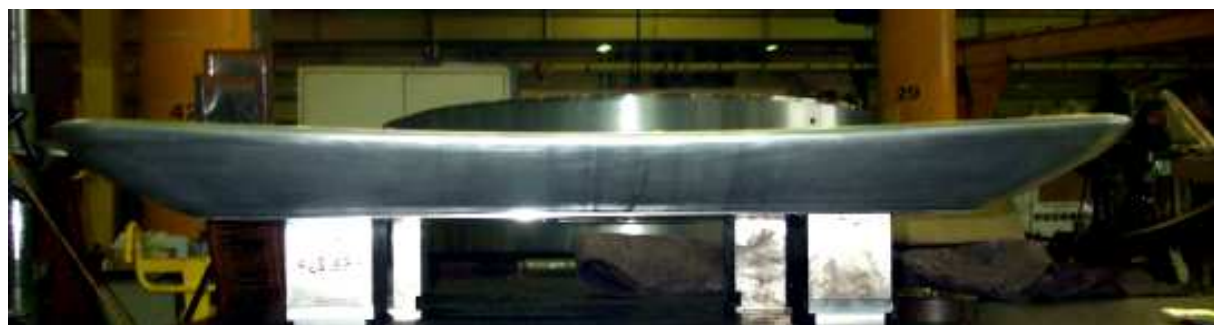
Figure 2 : Photographies du réflecteur (dans sa phase d'usinage).
