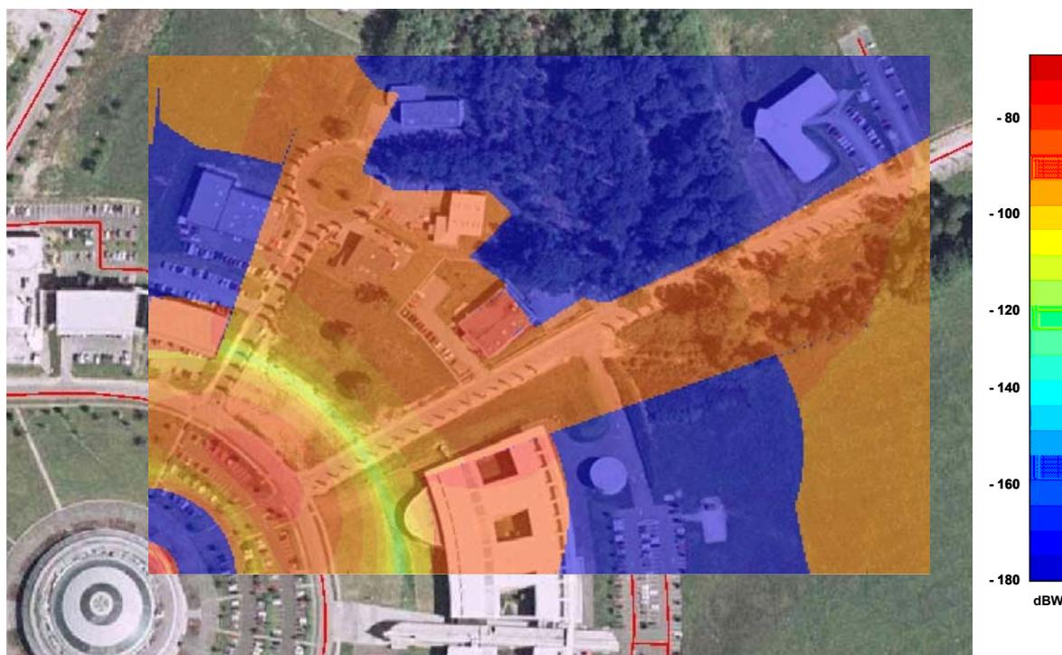
Figure III.16 : Couverture radioélectrique avec utilisation d'un réflecteur passif
