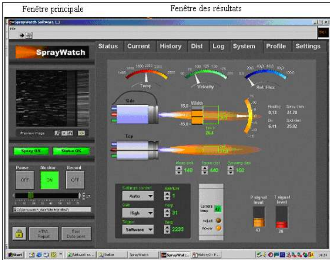
Figure 2.11 : Fenêtre d'affichage du SprayWatch [137]
