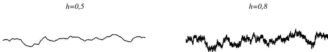
Figure 20 : Exemples de réalisations de profils avec la méthode des diamants avec la même série de nombres aléatoires ( N=10, N_{it}=10 ).
