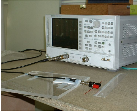
Figure 122 : Dispositif expérimental. Le dipôle est constitué de deux fils de 0.77 mm de rayon, 7.5 cm de long et éloignés de 2,2 cm.
