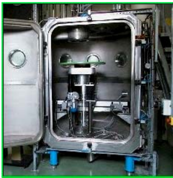
Figure II-18 : Enceinte utilisée pour recueillir les particules écrasées en projection par plasma inductif supersonique.
