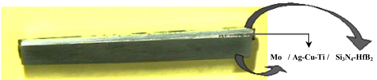
Figure 39 : Photo de l'assemblage Molybdène/Ag-Cu-Ti/ $\text{Si}_3\text{N}_4\text{-HfB}_2$ .
