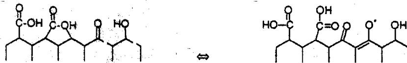
Figure 8 : Différents groupes oxygénés pouvant être générés à la surface du graphite.
