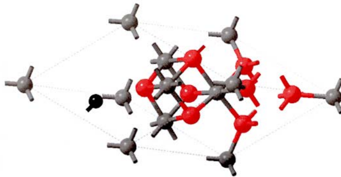
Figure II-5 : Maille de HA_5O_8 avec en rouge l'oxygène, en gris l'aluminium et en noir l'hydrogène
