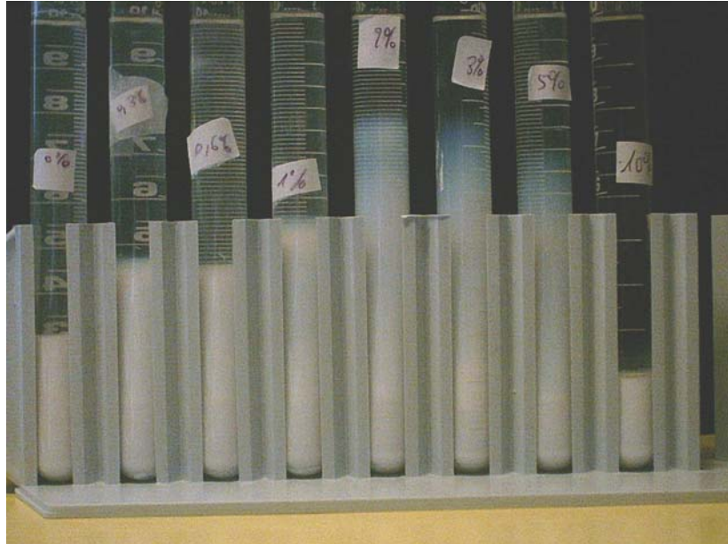
Figure II-25 : Sédimentation des suspensions dans des tubes à essai après un mois (dans l'ordre : suspensions avec 0%, 0,3%, 0,6%, 1%, 2%, 3%, 5% et 10% en masse de dispersant).
