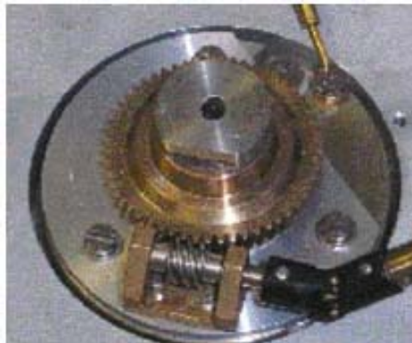
Figure 1.14 : platine porte-échantillon du MEB XL20
