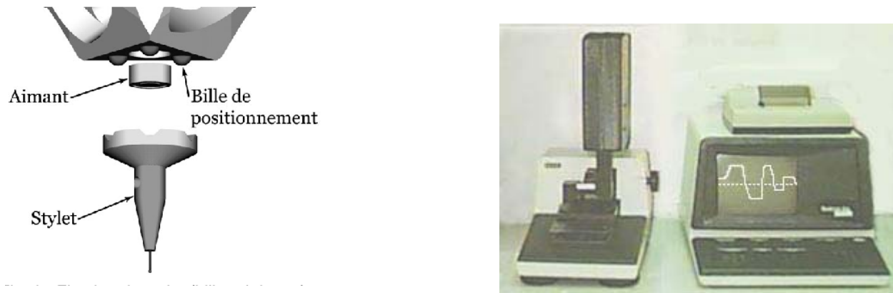
Figure 3.8 : profilomètre Dektak IIA [Ve-1]
