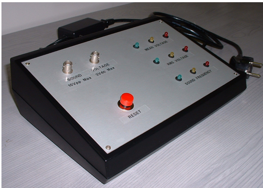
Figure 5-3 : Le module de contrôle de l'érosion des électrodes.
