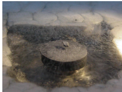
Figure 19: Lévitation d'un aimant sur une cible d'YBCO plongée dans l'azote liquide.
