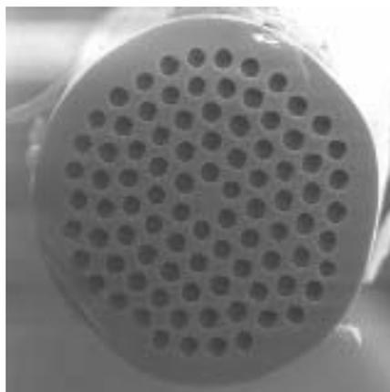
**Figure I-22 : Exemple de fibre à cristal photonique**
