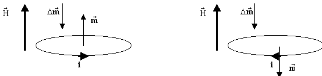
Figure 18 : Effet d'un champ magnétique sur deux électrons parcourant la même orbite en sens inverses
