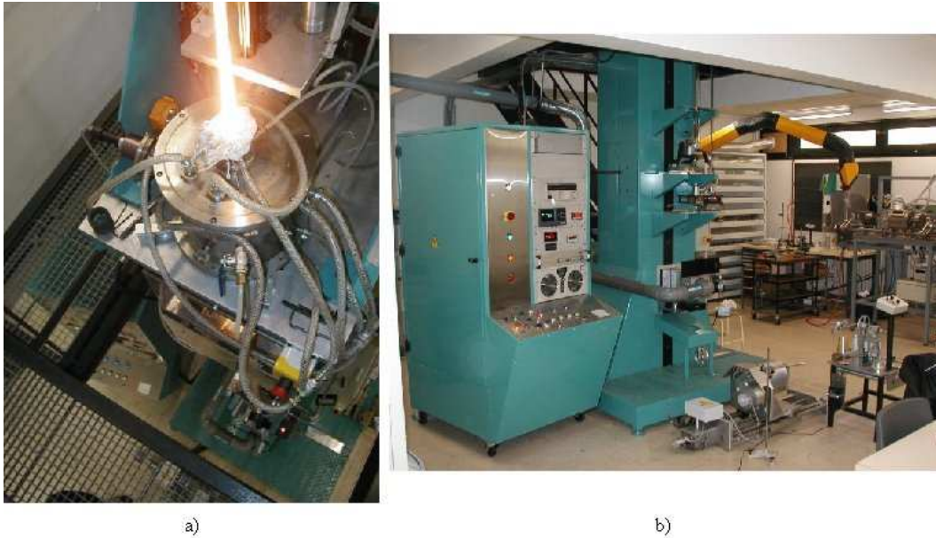
Figure 29. Tour de fibrage de l'Université-CNRS présente dans les laboratoires de l'équipe d'optique guidée et intégrée de l'I.R.C.O.M. : a) préforme et four à induction b) poste de contrôle et système d'induction de la fibre
