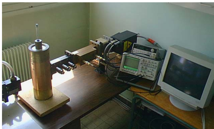
Photographie 2 : Système d'exposition avec le générateur SAIREM (200 - 2000 W).
