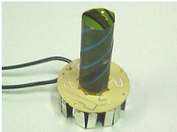
Figure I-12 : Exemple d'antenne quadrifilaire pour le système XM
