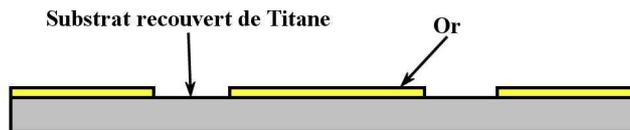
Pour réaliser des dispositifs MEMS à comportement capacitif, une couche de diélectrique est déposée soit, dans le cas de matériaux que l'on sait graver, par la même technique que celle utilisée pour graver l'or, soit en utilisant des résines de « lift-off ».
