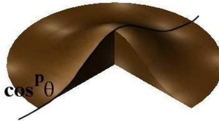
Figure 4-4 : Profil en épaisseur d'un dépôt sur substrat fixe
