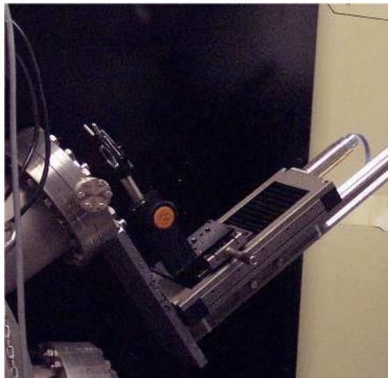
Figure 2-7 : Translation motorisée portant la lentille de focalisation
