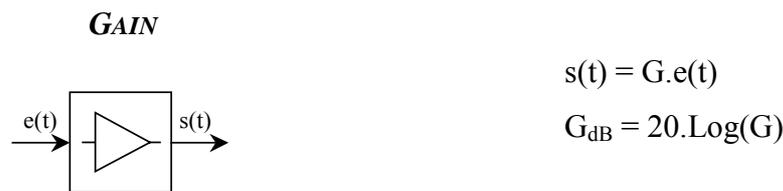
Figure III- 22 : Modèle de simulation de l'amplificateur électrique.
