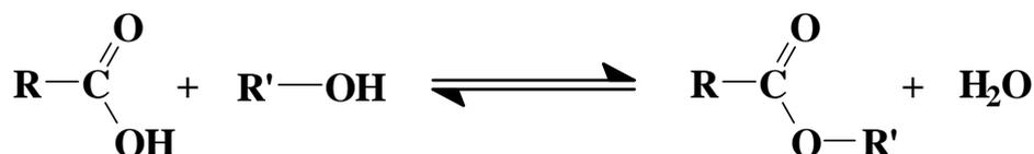
Figure 41 : Schéma général de la réaction d'estérification.
