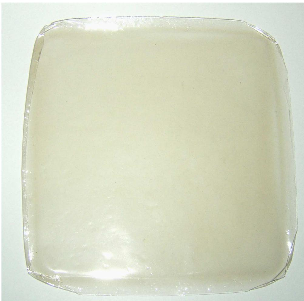
*Figure 114 : Film plastique de cellulose réticulée par métathèse ( $DS = 2,8$  ;  $T = 30\%$ ).*
