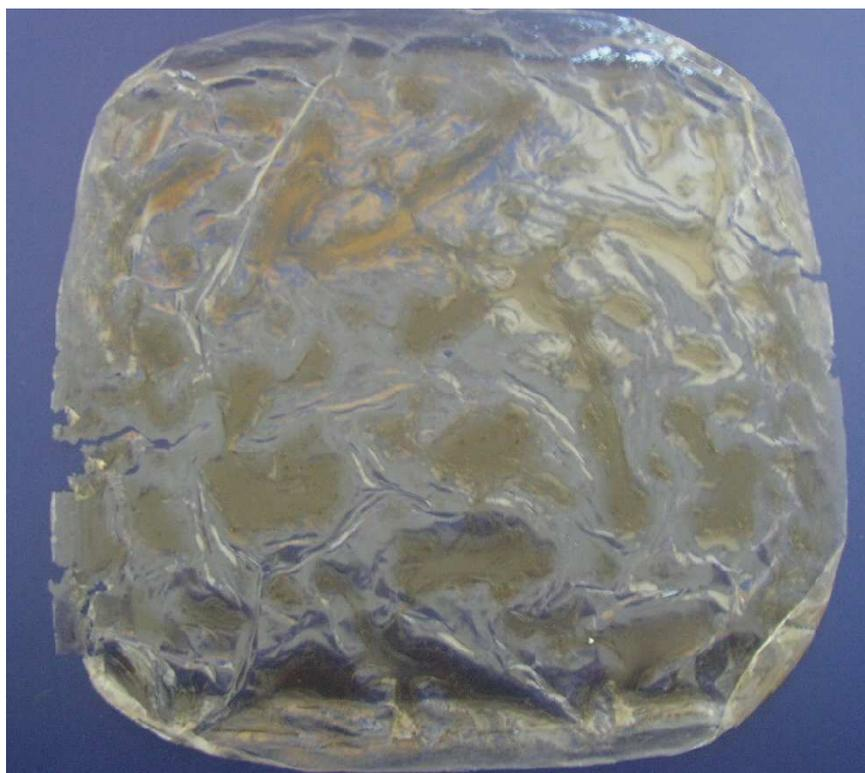
*Figure 119 : Photographie d'un gel de cellulose réticulée après casting.*
