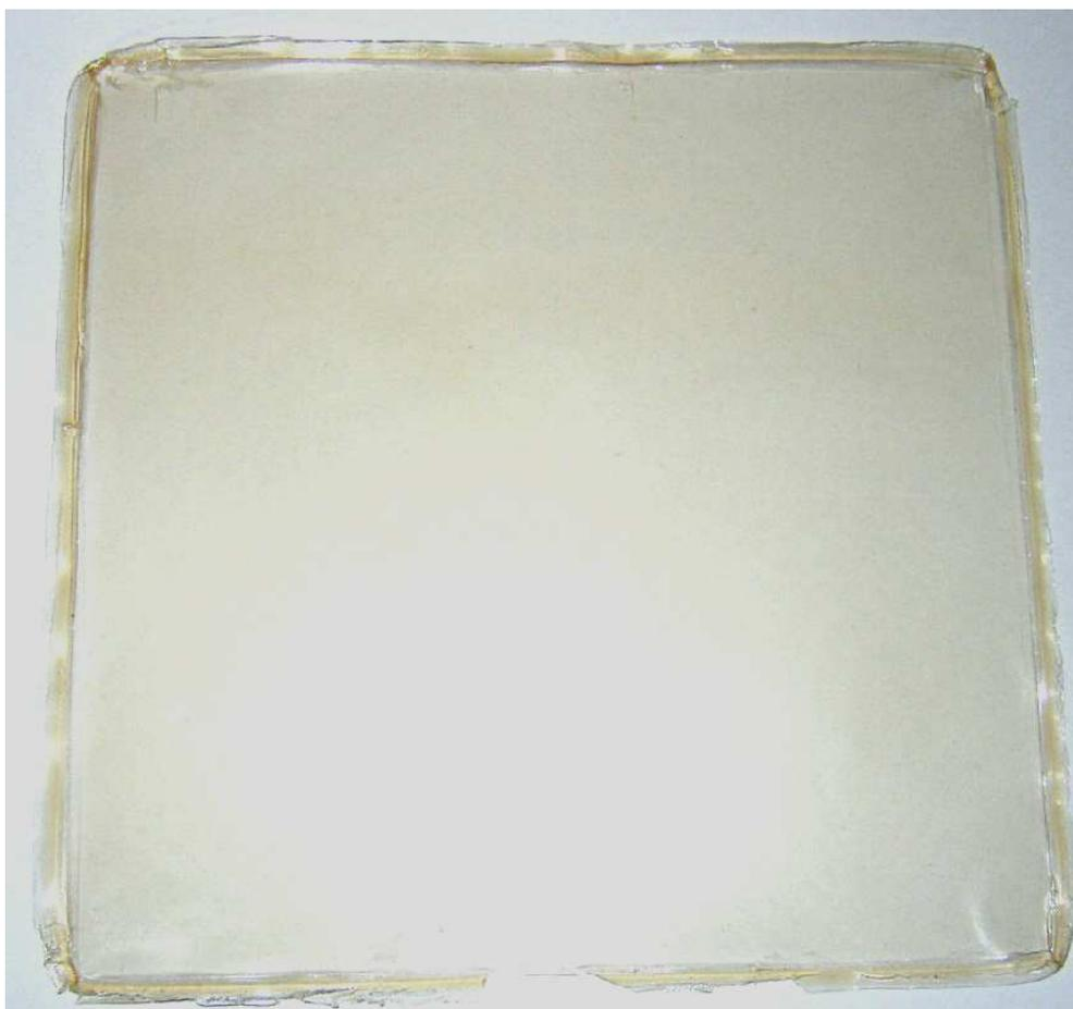
*Figure 72 : Film plastique de cellulose de châtaignier de DS = 2,2 synthétisé en présence de carbonate de calcium.*
