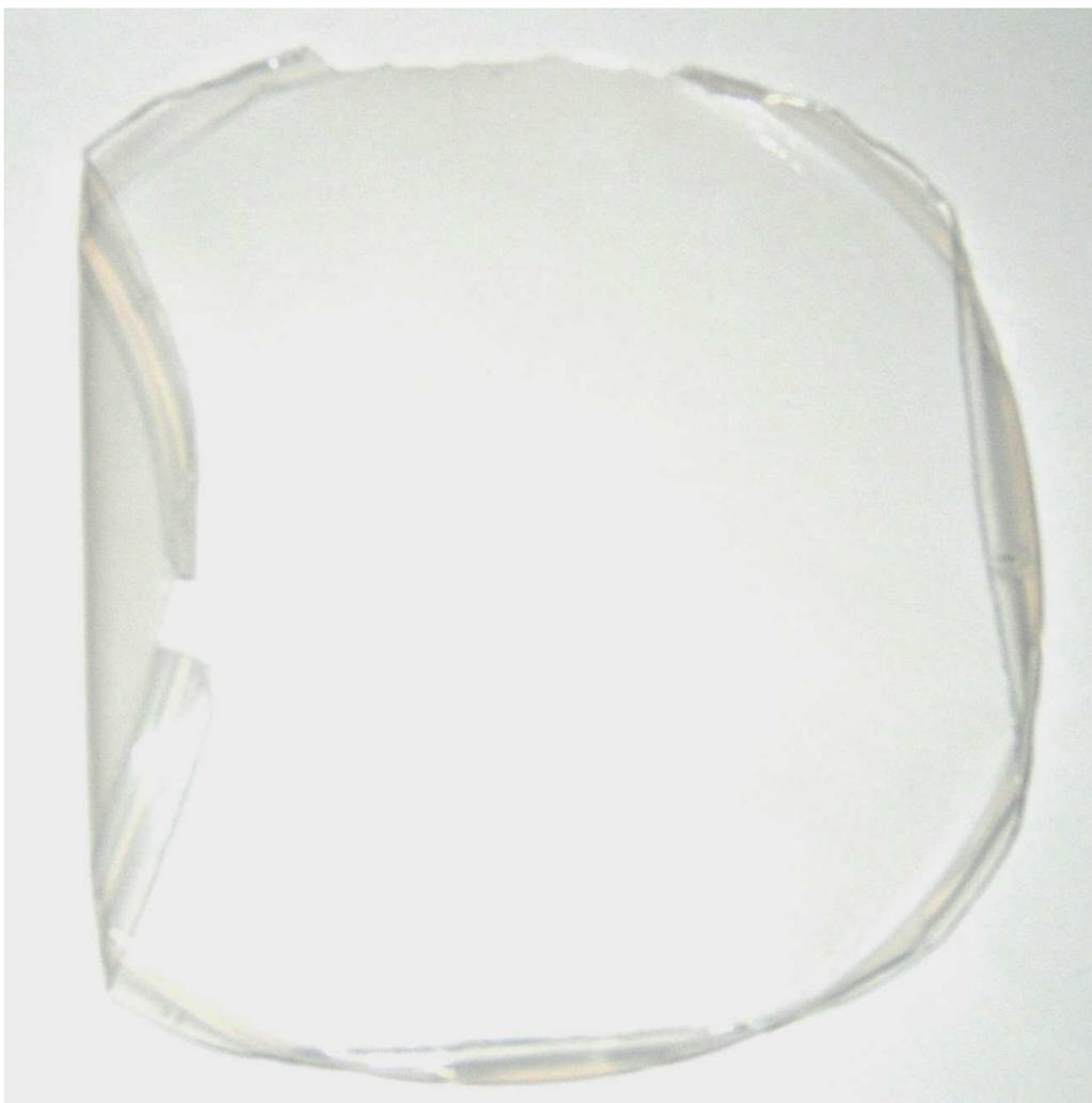
*Figure 66 : Film plastique obtenu après acylation de cellulose microcristalline en présence de carbonate de calcium.*
