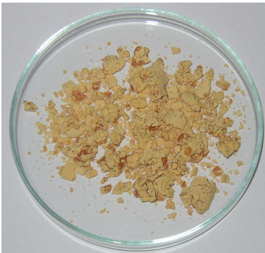
*Figure 128 : Ester linique de cellulose microcristalline.*
