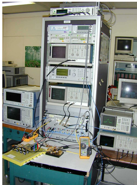
Figure 34 : Photo de la structure test du système de linéarisation pour une modulation numérique 16QAM. Sont présents le banc Télécom/NPR, l'amplificateur hybride dans le support de test Wiltron ainsi que la maquette du système de commande de polarisation.
