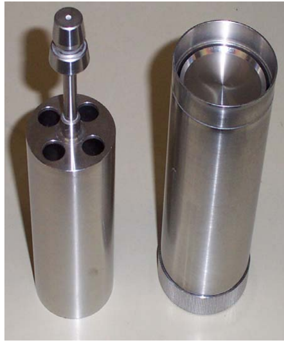
Figure 12 : cellule de mesure Z1 DIN à double entrefer.
