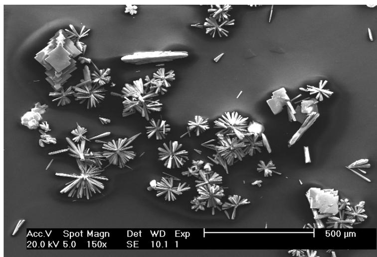
Figure 34 : Image réalisée au microscope électronique à balayage du précipité obtenu après vieillissement, à 60°C, d'un autre gel préparé avec  $R = 65$  et  $C_f = 0,1$  mol/L.
