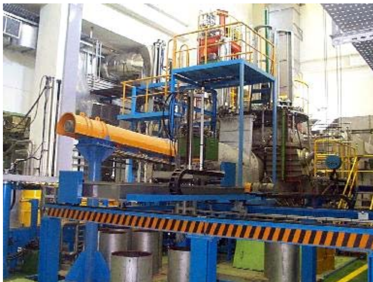
Figure I-8 : Four de traitement des déchets radioactifs de très faible activité (INER)
