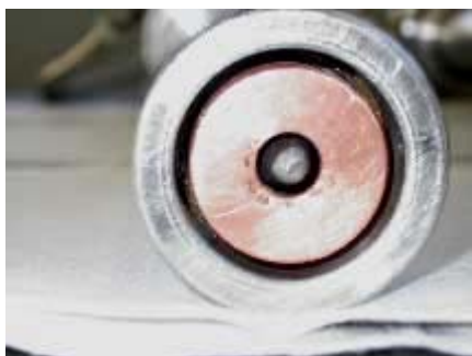
Figure II-3 : Photographie de la cathode associée à ses manchons
