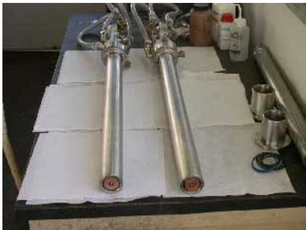
Figure II-2 : Photographie des torches jumelées bipolaires
