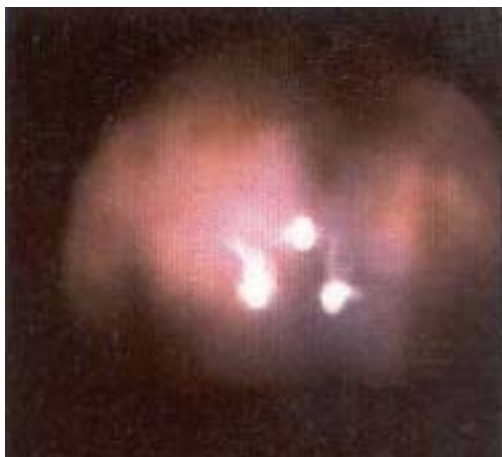
Figure I-16 : Eclatement d'un arc électrique triphasé entre 3 électrodes
