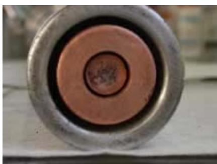
Figure II-4 : Photographie de l'anode associée à ses manchons
