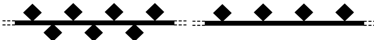
Figure III.11 : Réseaux linéaires à patches alternés ou non
