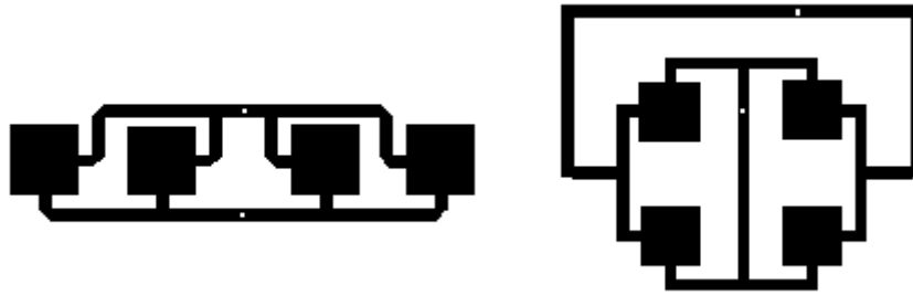
Figure IV.42 : Réseaux à double polarisation linéaires
