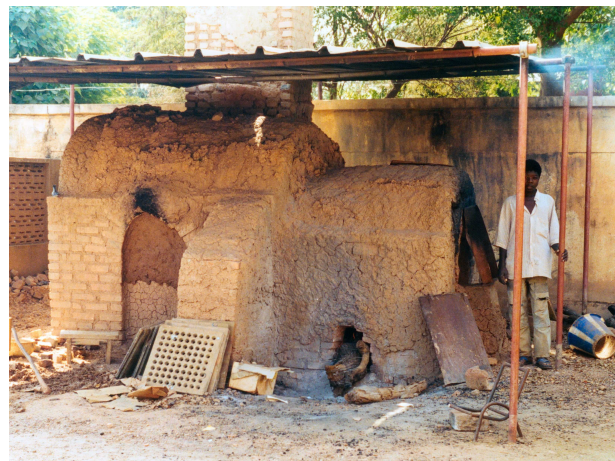
Figure iv: Modèle de four de potier fermé, alimenté au bois.
