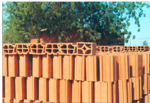
Figure vi: Briques de pisé extrudées et séchées à l'air.
