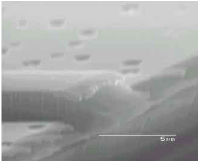
Figure 63: Visualisation au MEB d'une face d'entrée, avec un wafer d'une épaisseur supérieure à 500 \mu\text{m} , après clivage.
