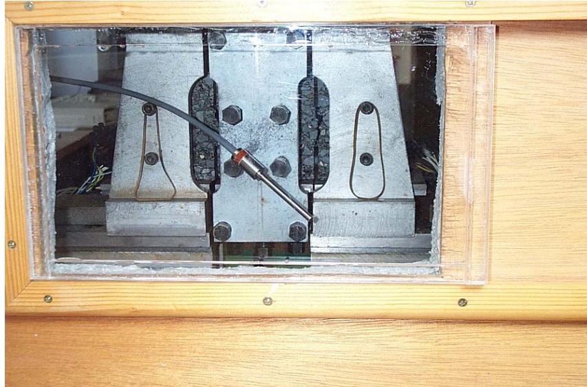
Photo IV.4 – Sonde thermique installée sur la face arrière de l'éprouvette (fissurée)
