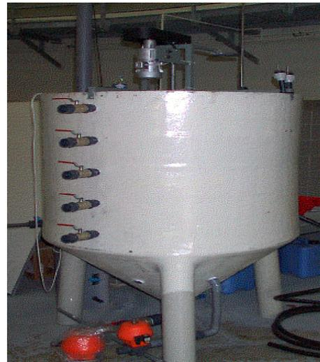
Figure II-6 : Pilote de 1320 L, échelle semi industrielle
