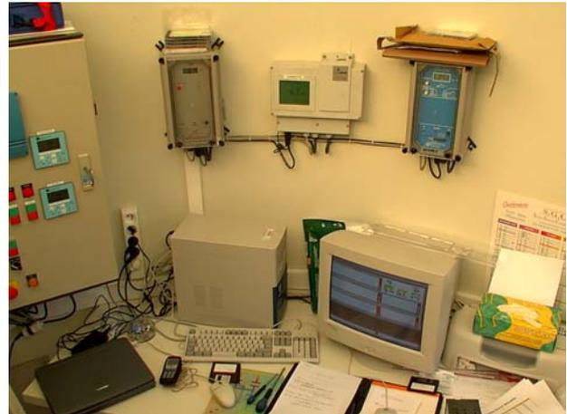
Figure II-7 : Le pilote et les différents capteurs et actionneurs reliés à l'automate      Figure II-8 : Le système d'acquisition OPC Factory
